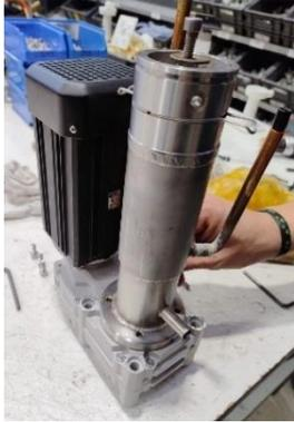
6. Colocar las arandelas y tornillos sin apretar para situar el evaporador al motorreductor.
