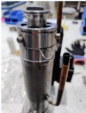
14. Colocar la boca de salida de hielo y el aislamiento. Embridar el aislamiento.
