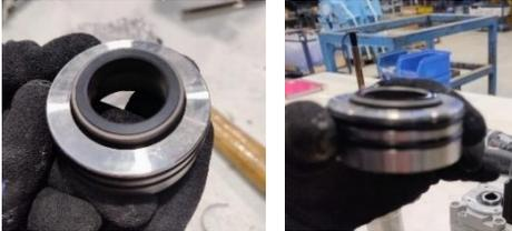
Aplicar lubricante alimentario aprobado por NSF, o su equivalente local, en las dos juntas tóricas para mejorar el ensamblaje del evaporador.
