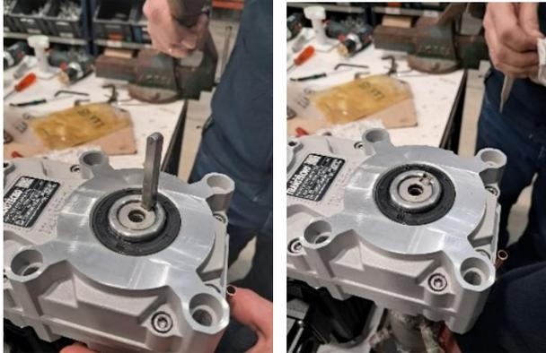
9. Colocar la arandela y el tornillo en la parte de abajo del motorreductor.
