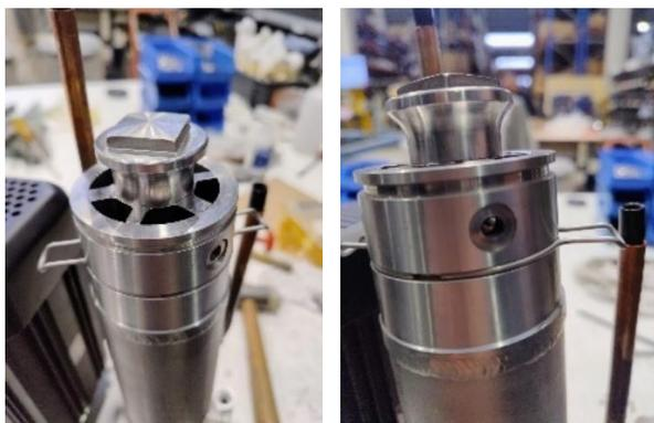
13. Colocar las arandelas y tornillos para sujetar el montaje del extrusor.
