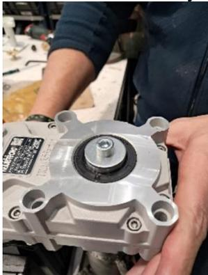
10. Colocar el anillo de sujeción y la junta tórica sobre el evaporador.
